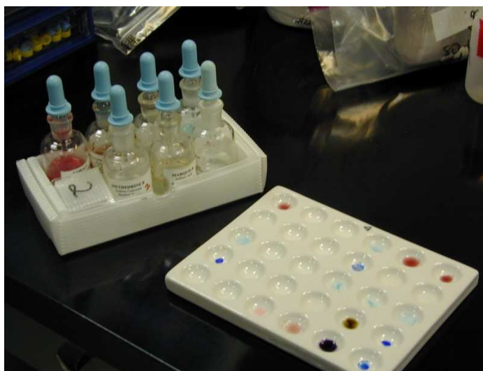
Rys. 3. Zestaw do analizy kroplowej [19]
