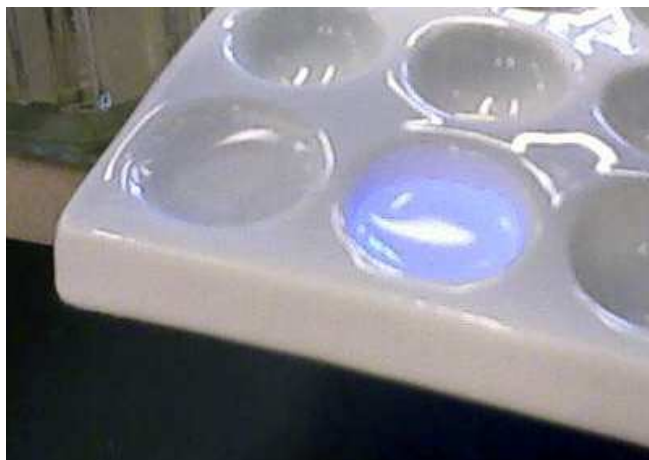
Rys. 5. Produkty reakcji chininy ze stęż. kwasem siarkowym wykazują intensywną fluorescencję w świetle UV
