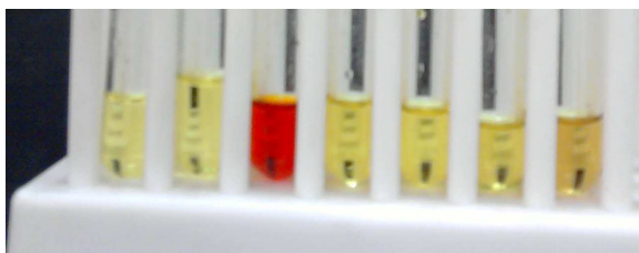
Rys. 57. Wyniki reakcji wybranych sulfonamidów z aldehydem anyżowym wobec stęż. kwasu siarkowego (przed dodaniem wody).
