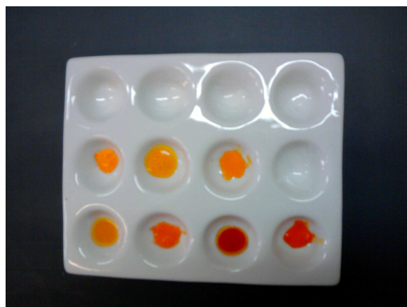
Rys. 55. Wyniki reakcji sulfonamidów z odczynnikiem Ehrlicha.
