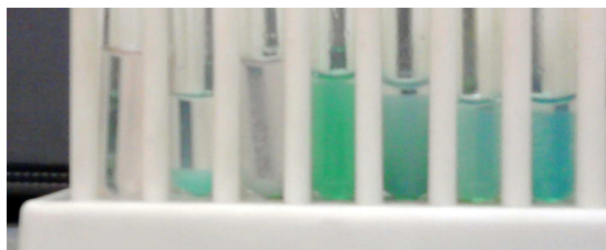
Rys.54. Barwy połączeń sulfonamidów z jonami \text{Co}^{2+} .
