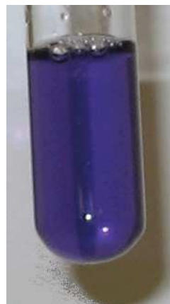
Rys. 94. Pozytywny wynik reakcji \alpha -aminokwasu z ninhydrną
