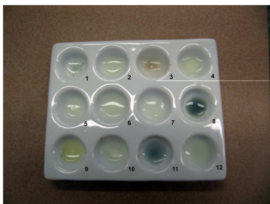
Rys. 101. Wyniki działania kwasu fosforowolframowego na wybrane aminokwasy. 1 - Arg (kolor szary) , 2 - His, 3 - Trp (kolor brązowy), 4 - Tyr, 5 - Phe, 6 - Pro, 7 - Ser, 8 - Lys (kolor szaroniebieski), 9 - Met (kolor cytrynowożółty), 10 - cystyna, 11 - Cys (kolor szaroniebieski), 12 - Gly.
